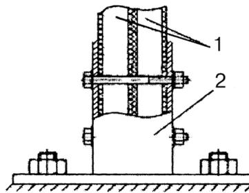
1 – стойки секций; 2 – закладной элемент
