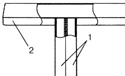
1 – стойки секций; 2 – профиль поручня
