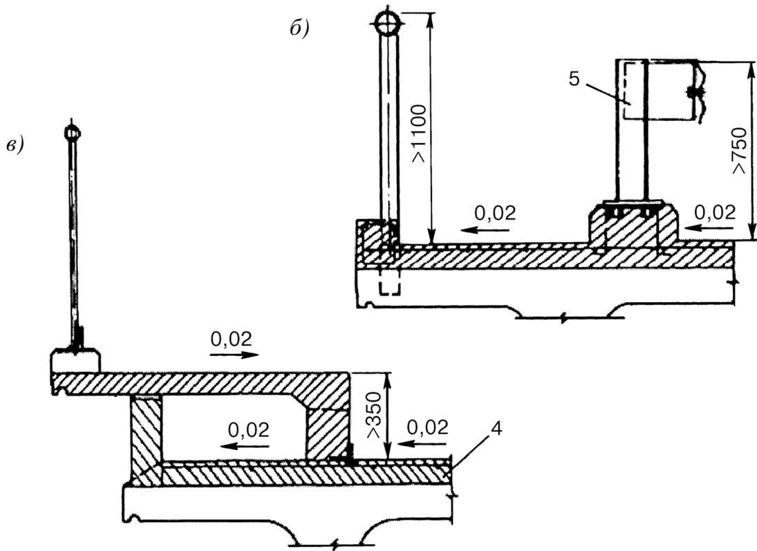
а) – тротуары; б) – тротуары непосредственно на пролетном строении; в) – тротуары
