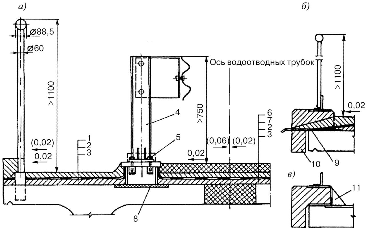
*a)* – без карнизного блока; *б)* – с карнизным блоком; *в)* – крепление карнизного блока (в скобках приведены значения при водоотводе через трубки);
