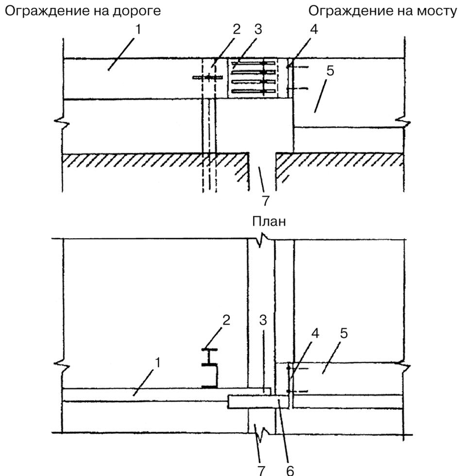
1 – металлическое барьерное ограждение; 2 – первая стойка металлического барьерного ограждения; 3 – стык; 4 – фланец на шпильках; 5 – парапетное железобетонное ограждение; 6 – приваренный к фланцу отрезок направляющей балки; 7 – шов пролетного строения
