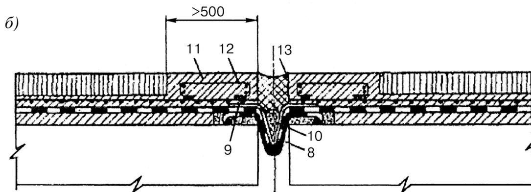
а) – ступенчатая вырубка слоев одежды и установка компенсатора; б) – устройство гидроизоляции покрытия и заполнение зазора;
