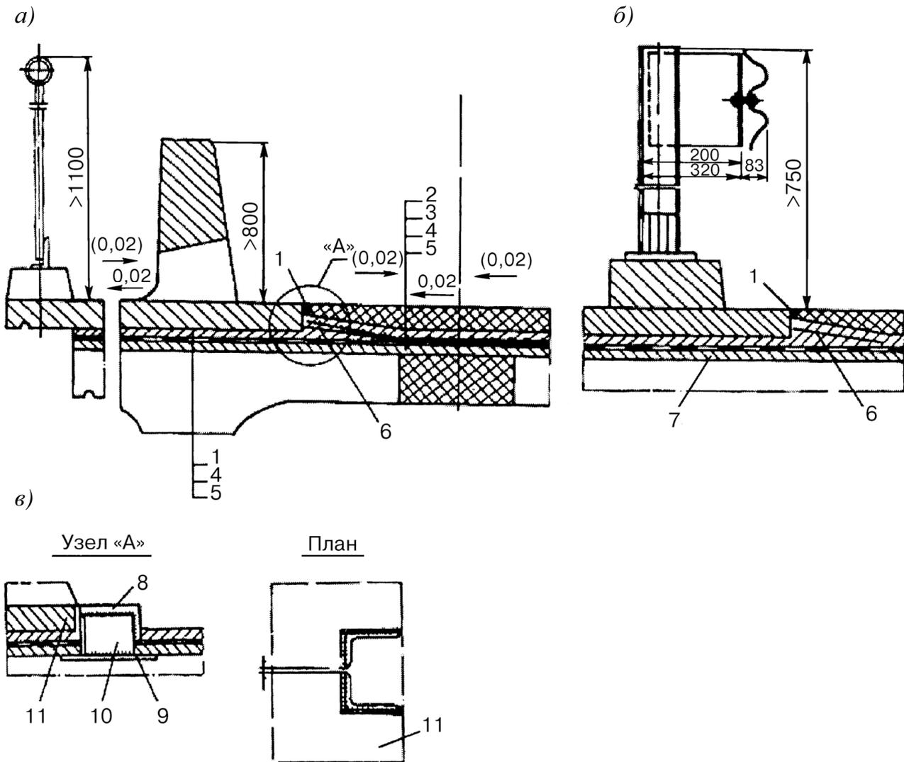
*а)* – с парапетным ограждением; *б)* – с металлическим барьерным ограждением; *в)* – крепление тротуарного блока (в скобках приведены значения при водоотводе через трубки);
