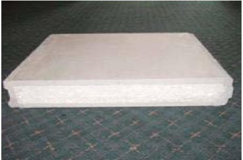
Пустотелая плита перекрытия из плотного БКМВ-бетона
